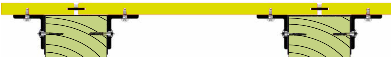
Balkonbodemplaat op houten draagbalken blind bevestigd (geschroefd)
