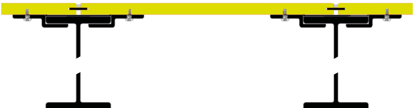
Balkonbodemplaat op stalen draagbalken blind bevestigd (geschroefd)
