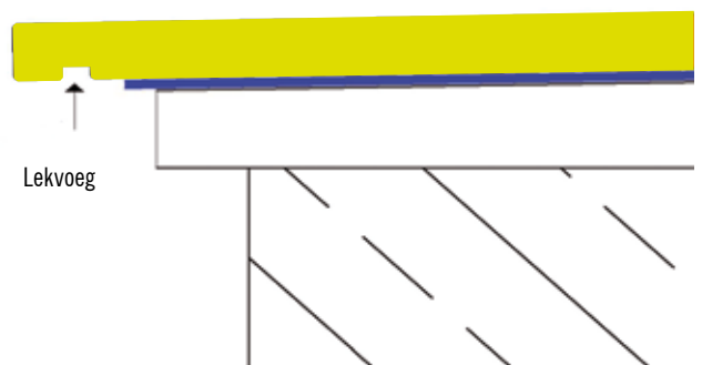
Verticale doorsnede principe van een lekvoeg
